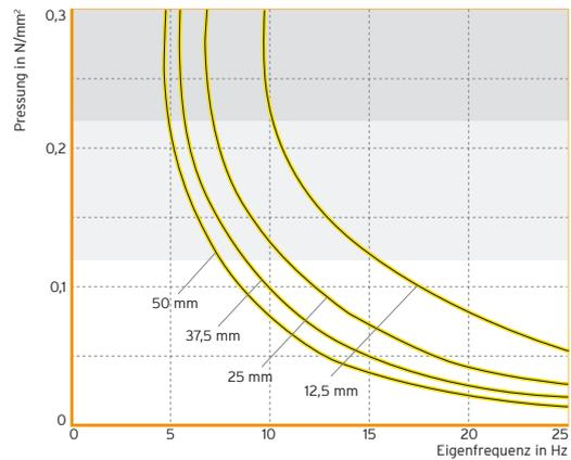
Eigenfrequenz eines Schwingensystems mit einem Freiheitsgrad, bestehend aus einer starren Masse und einer elastischen Lagerung aus Sylodyn® NC auf unachgiebigem Untergrund; Parameter: Dicke des Sylodyn®-Lagers
