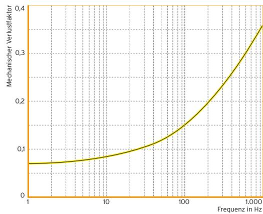
DMA-Untersuchungen; Masterkurve mit einer Referenztemperatur von 21 °C; Messungen im linearen Bereich der Federkennlinie, bei geringer Pressung
