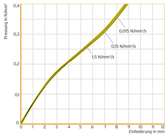
**Amplitudenabhängigkeit:** Vorlast bei stat. Dauerlast; Formfaktor:  $q=3$ , Materialdicke 25 mm
