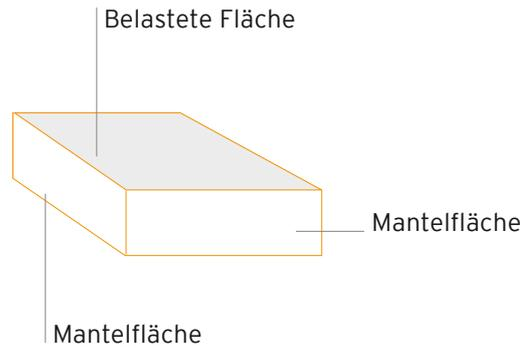
Der Formfaktor hat einen Einfluss auf die Einfederung bzw. auf den Grenzwert der statischen Dauerlast.
