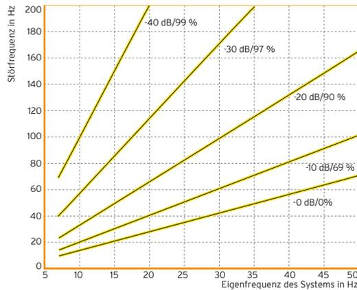
Verminderung der Übertragung mechanischer Schwingungen durch den Einbau einer elastischen Lagerung aus Sylodyn® NC
