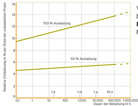
Verformungszunahme unter gleich bleibender Druckbelastung
