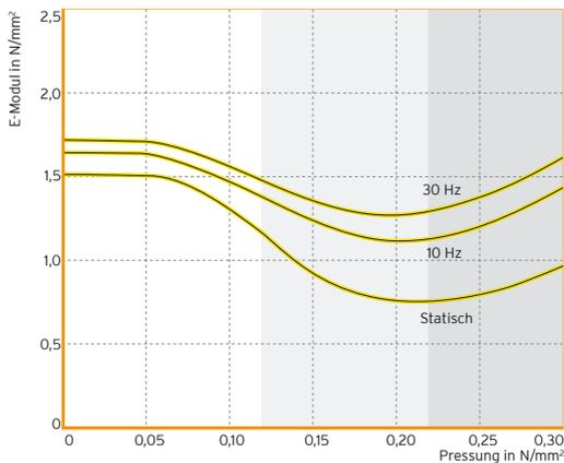
Statischer E-Modul als Tangentenmodul aus der Federkennlinie; Dynamischer E-Modul aus sinusförmiger Anregung mit einer Schwingsschnelle von  $100 \text{ dBv re. } 5 \cdot 10^{-8} \text{ m/s}$ ; Messung in Anlehnung an DIN 53513
